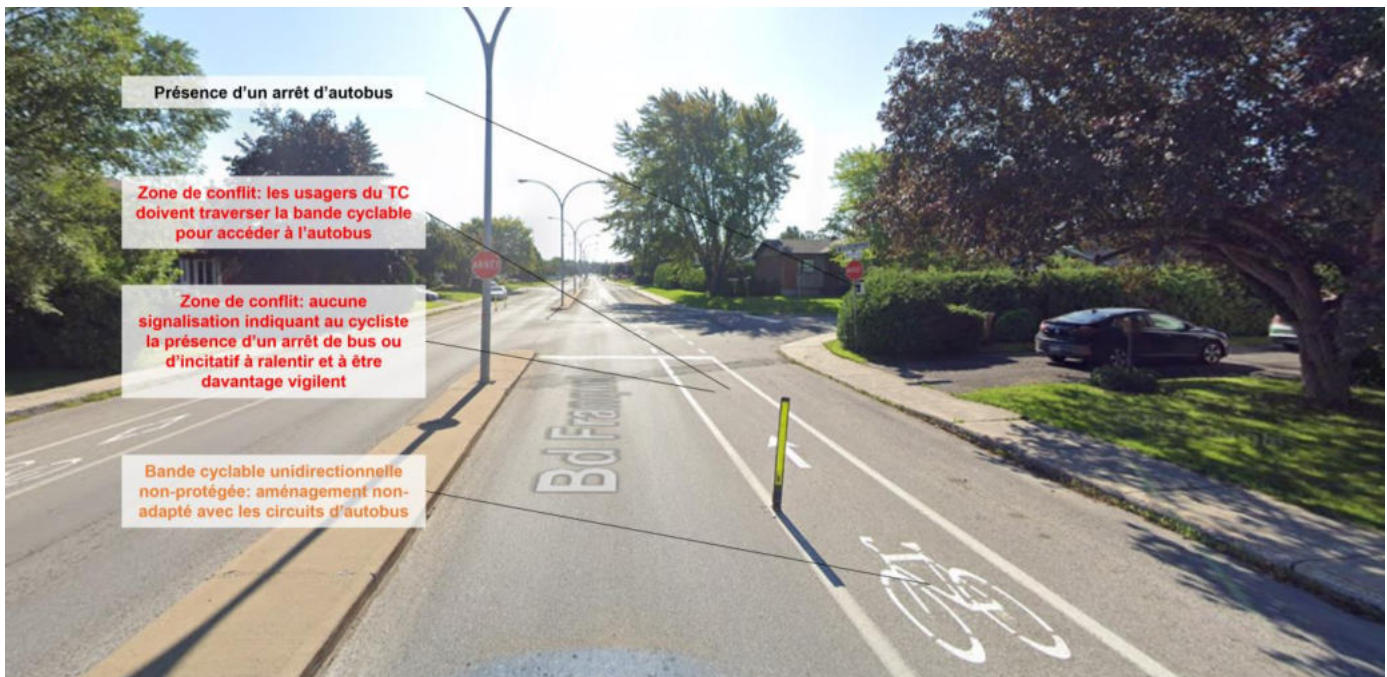
Figure 4-9 : Enjeux liés à la présence d'un arrêt d'autobus en bordure d'une bande cyclable unidirectionnelle (exemple de l'intersection du boulevard Franquet et de la rue Scheffer)
