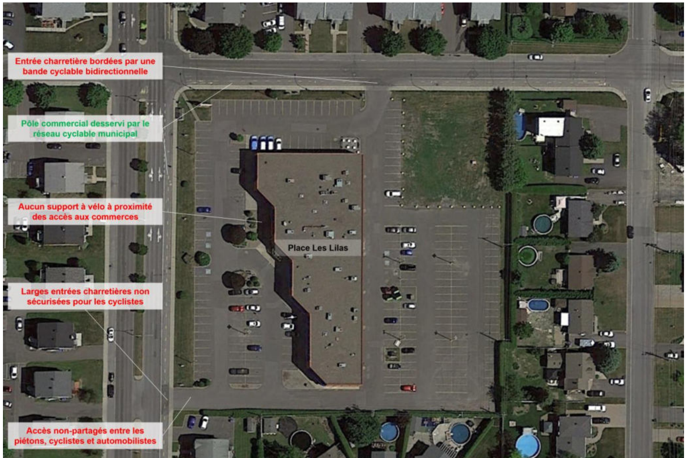
Figure 4-17 : Enjeux de sécurité et d'accessibilité à vélo aux pôles commerciaux en milieu résidentiel (exemple de la Place Les Lilas à l'intersection du boulevard Brassard et de la rue Barré)
