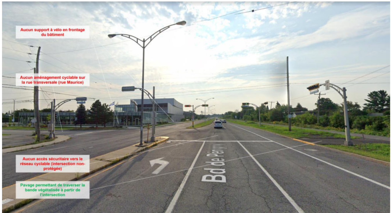
Figure 4-18 : Enjeux de sécurité et d'accessibilité à vélo aux grands équipements sportifs et culturels (exemple du Pôle culturel de Chambly à l'intersection du boulevard De Périgny et de la rue Maurice)
