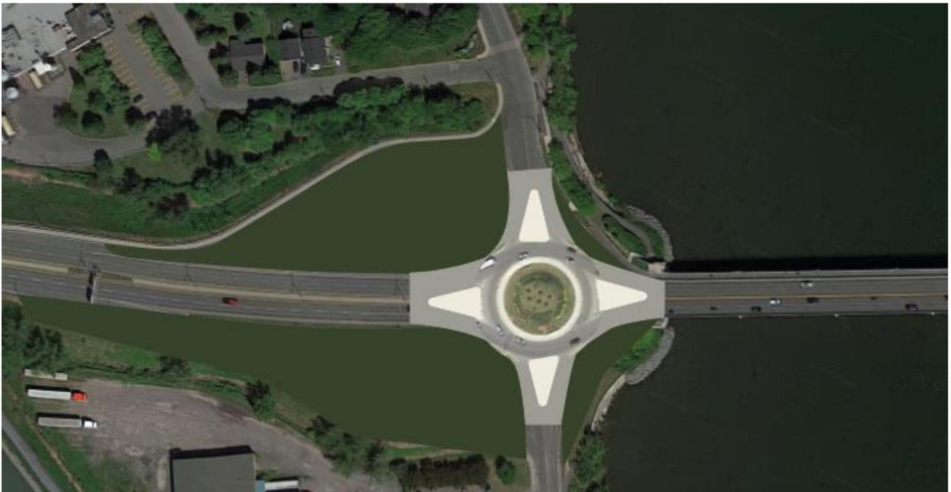
Figure 4.4 : Représentation conceptuelle d'un carrefour giratoire à deux voies à l'entrée de ville est de Chambly (De Périgny / Bourgogne (Yule))
