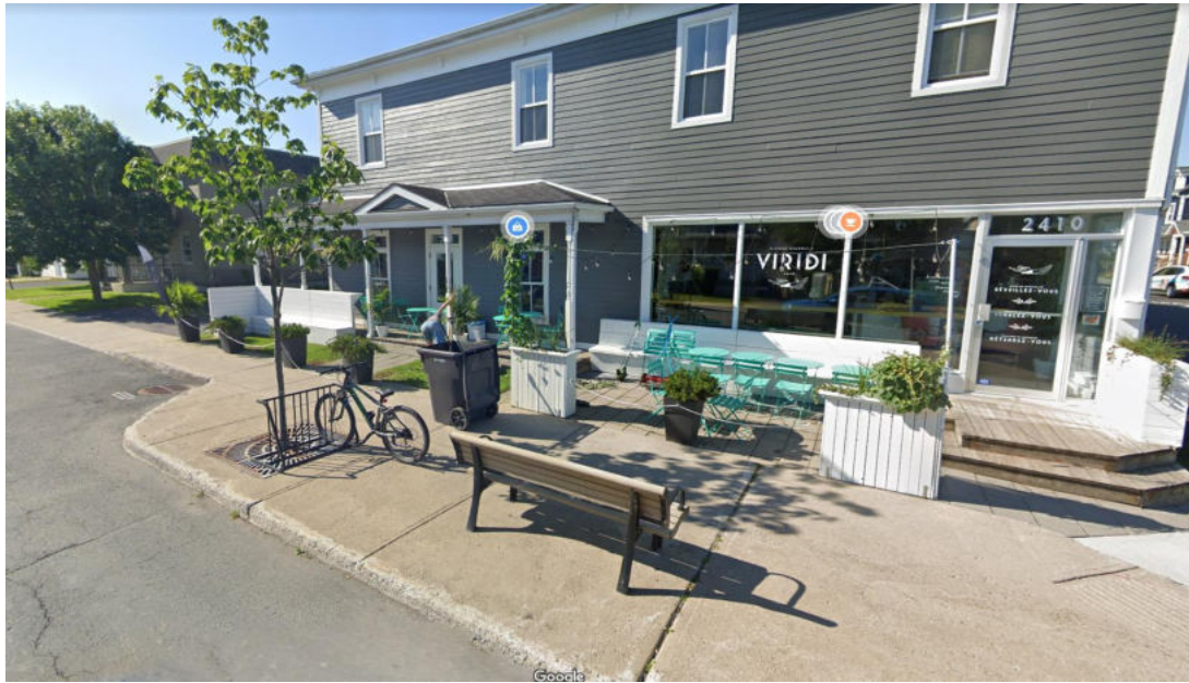
Figure 4-5 : Support à vélo sur une saillie de trottoir élargi à l'intersection de l'avenue Bourgogne et de la rue de l'Église
